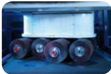
Rotationseinheit mit 8 gegenläufigen Bürsten
