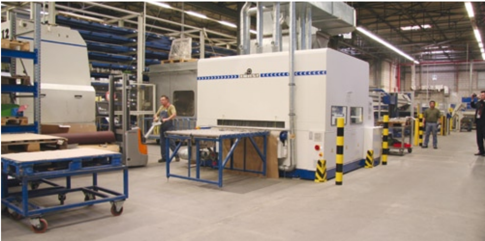
Wofür früher zwei Maschinen nötig waren, reicht heute eine: Die EG M /Rotation von Ernst integriert Schleifwalze und Rotorkopf mit Lamellenbürsten.
