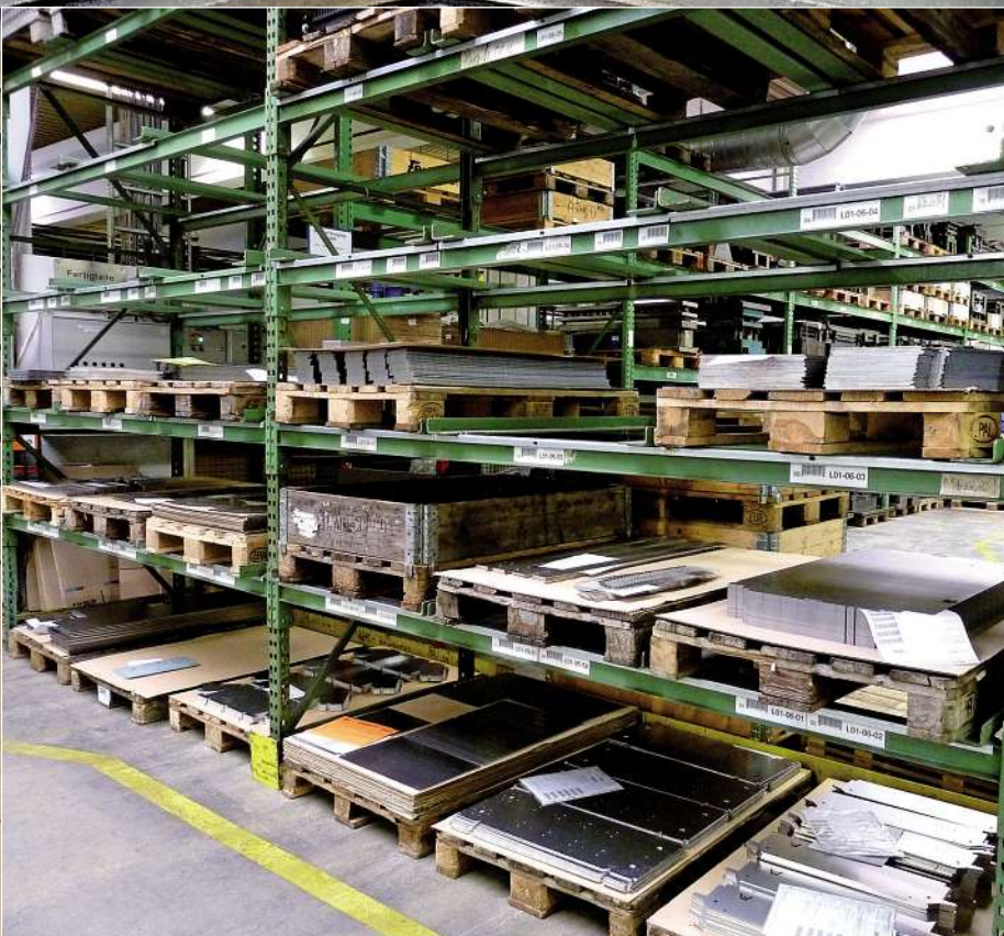
In diesem Regal lagern Tonnen von vorgearbeiteten Blechen, die auf ihre Kantenbearbeitung auf der Ernst-Nassschleifmaschine warten.
