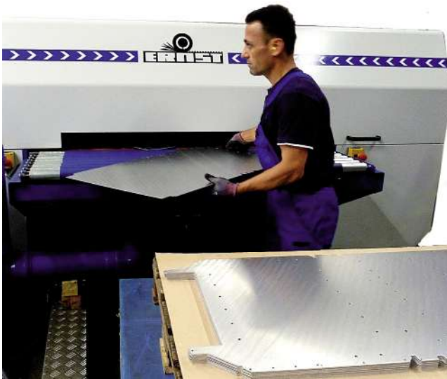
Geschafft: Die kantenbearbeiteten Platinen werden von Hand gestapelt und dem nächstfolgenden Fertigungsschritt – vielleicht dem Biegen oder Kanten – zugeführt.
